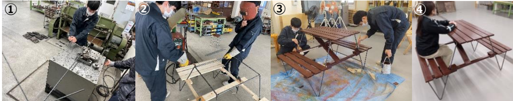
①鉄筋の折り曲げ。 ②鉄筋溶接。 ③塗装。 ④完成。
