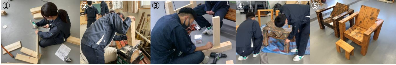
①木材のカット。 ②やすりがけ。 ③ビスの打ち込み。 ④塗装。 ⑤完成。
